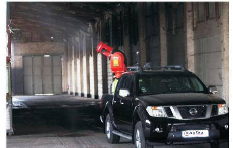
Sprühfahrzeug mit dem die komplette Halle vom Boden bis zur Decke eingesprüht werden kann. Der jahrelange Staub wird durch den enormen Druck der Sprühkanone weggefegt.
